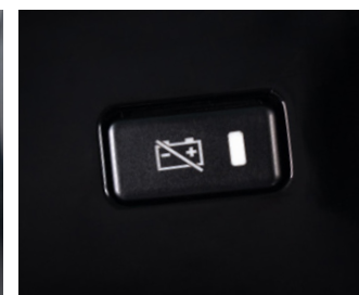
ปุ่มตัดการทำงานของแบตเตอรี่
